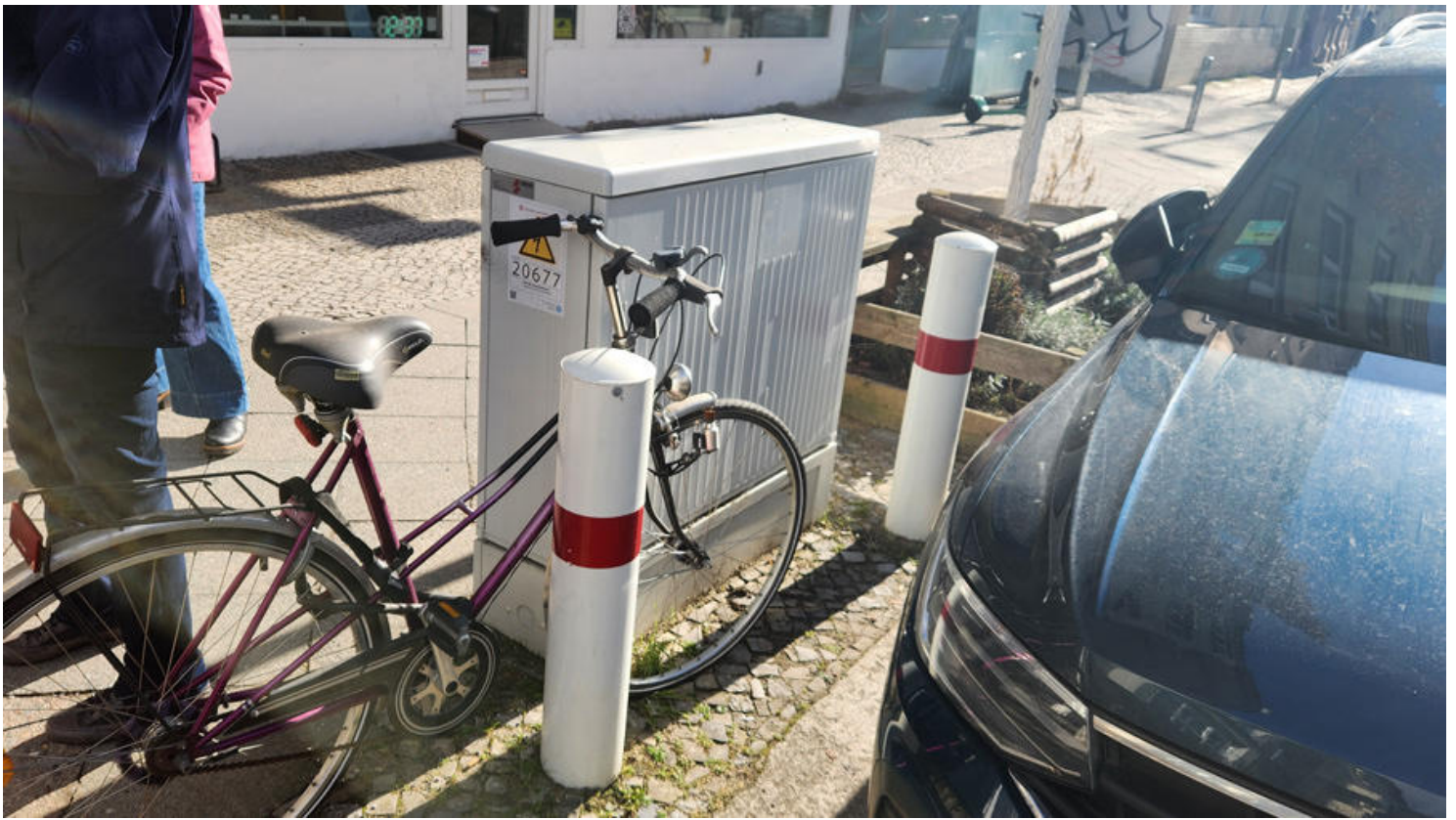
Leberstraße 39 • nicht behindernde Gehwegpoller im Unterstreifen, die den Verteilerkasten schützen
